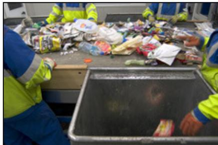
**Figure 1 : Chaîne de pré-tri manuel d'un centre de tri**
