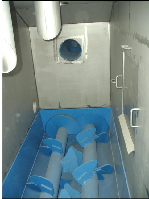
**Figure 43 : Intérieur d'un malaxeur pompe**
