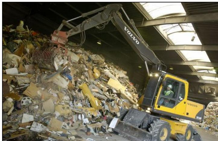
**Figure 4 : Pré-tri des objets encombrants par grappin**
