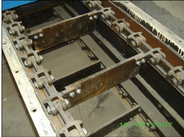
**Figure 47 : Intérieur d'un convoyeur à chaînes**
