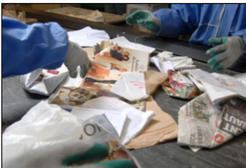
**Figure 4 : Chaîne de tri manuel d'un centre de tri**
