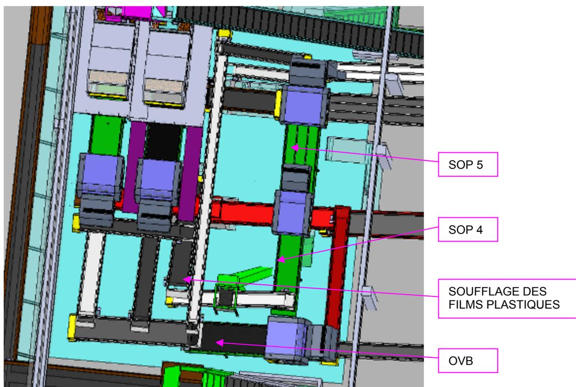
Cette séparation est assurée par un séparateur de films plastiques, d'un séparateur des ferreux suivis de deux séparateurs optiques SOP4 et SOP5 en série.
