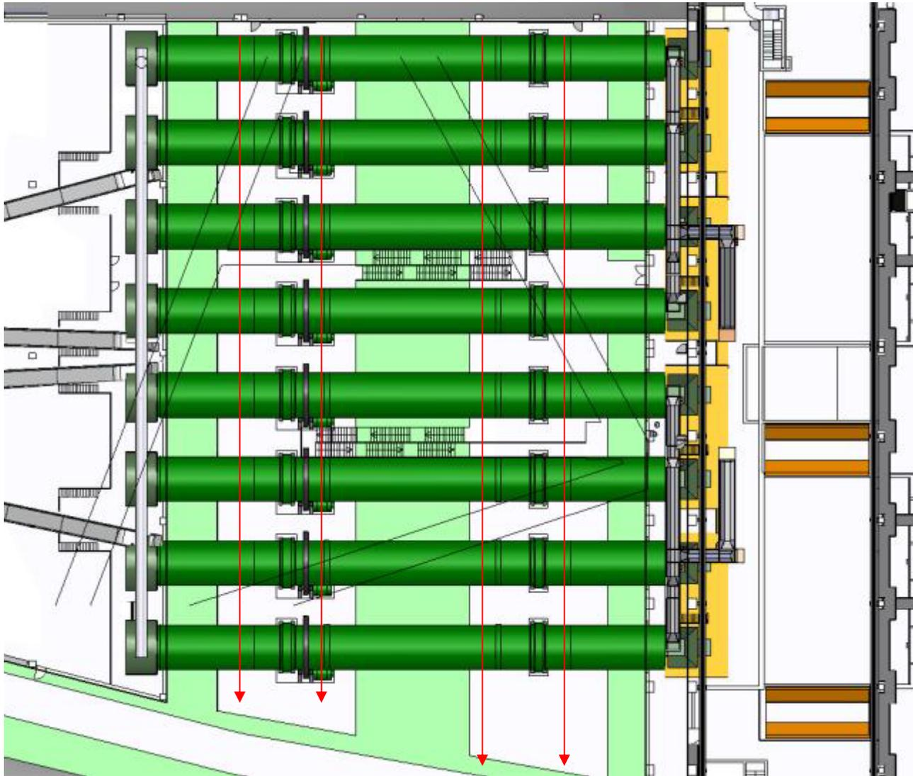
Deux zones de circulation (hors surface végétalisée) supportant une charge de  $5t/m^2$ , sont prévues afin d'évacuer les éléments de la zone et les charger sur un camion à l'aide d'une grue mobile.
