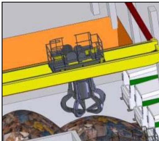
Trois zones ont été réservées afin de pouvoir réaliser d'une part un contrôle qualitatif des collectes par déversement au sol d'une benne OMR et d'autre part l'entretien des grappins.
