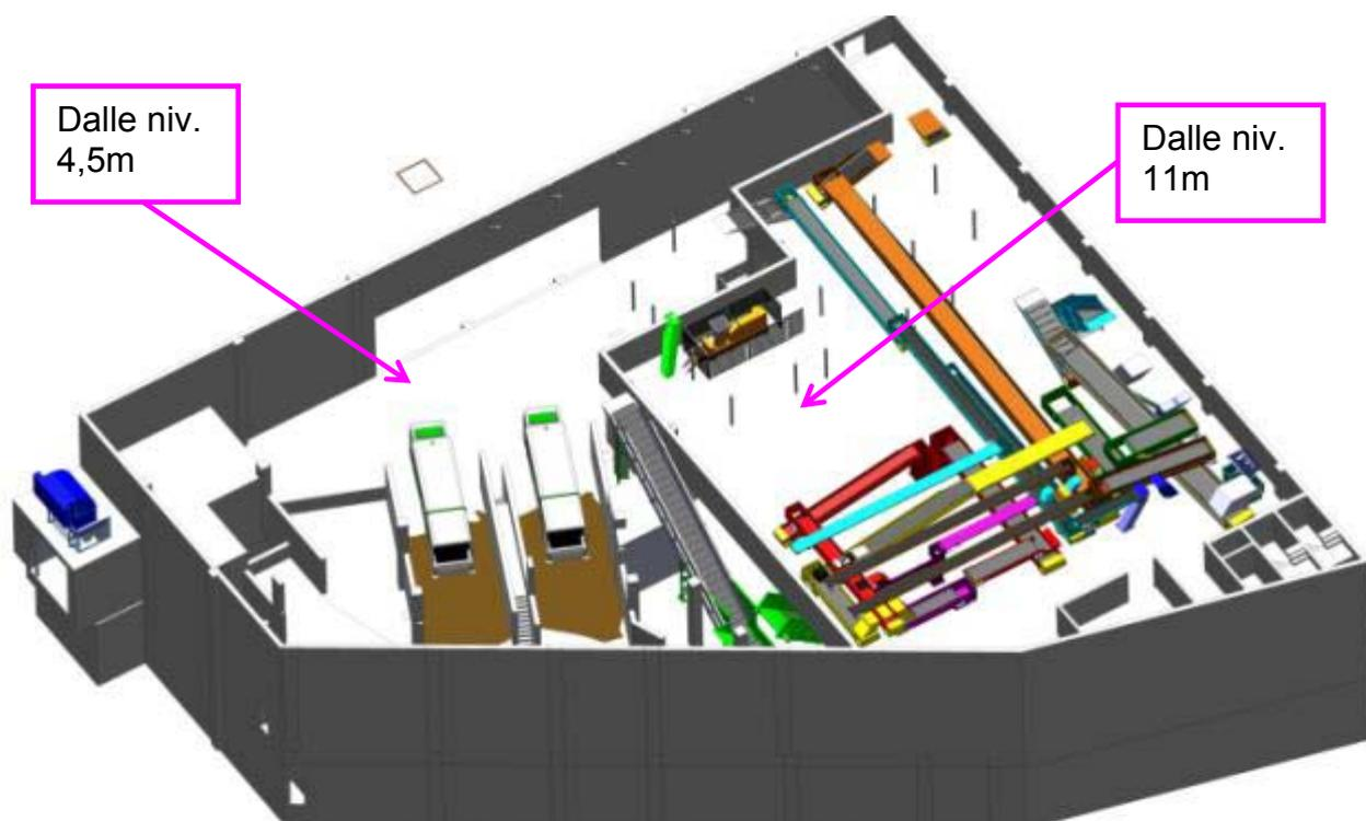
Cette dalle permet de favoriser les accès pour les opérations de maintenance sur les convoyeurs de transfert. Tous les convoyeurs sont à portée, à moins de 2 mètres du sol.
