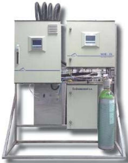
*Analyseur Multigaz à infrarouge par corrélation de filtres gazeux*
