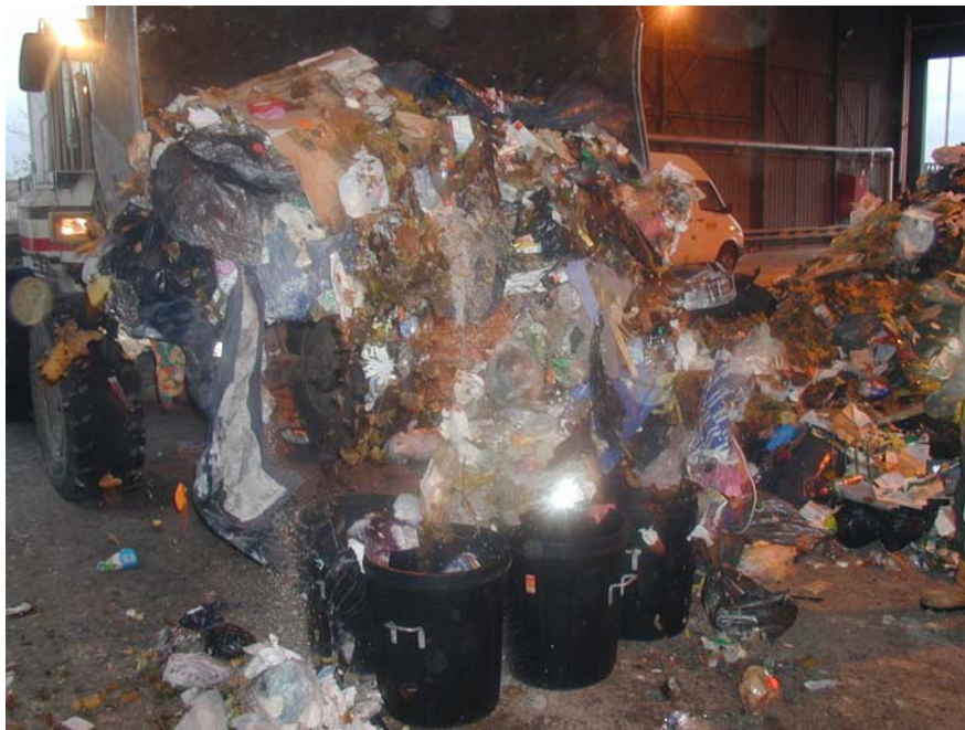
Figure 1 : Constitution d'un prélèvement élémentaire d'OMr
