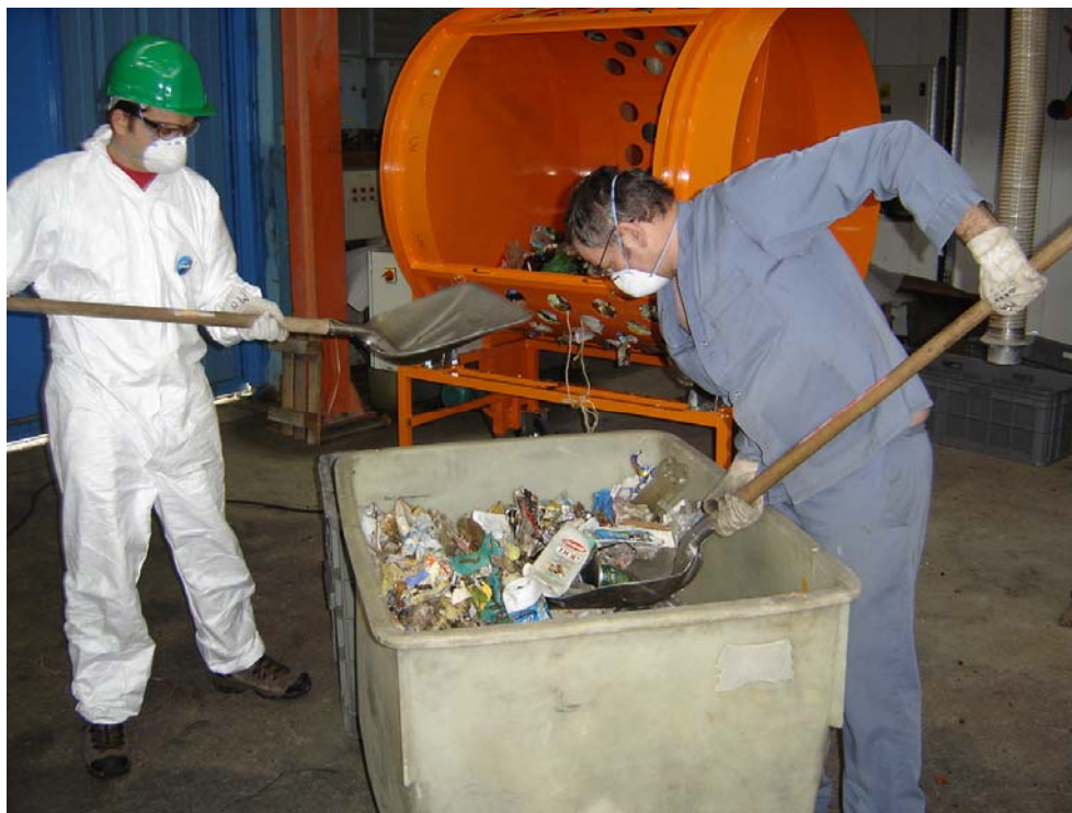
Figure 4 : Remplissage du trommel pour criblage
