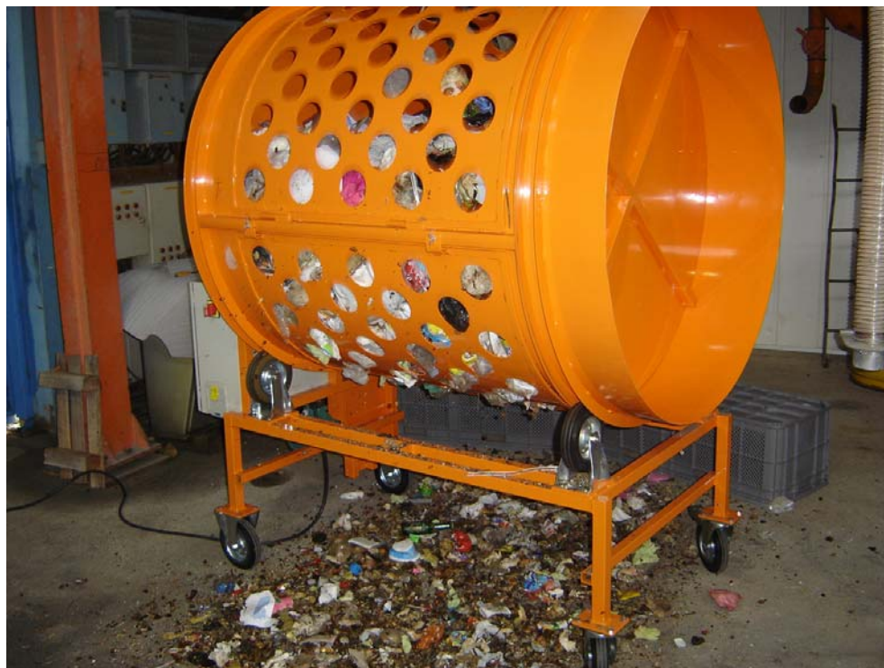
Figure 5 : Criblage au trommel à la maille de 100 mm.
