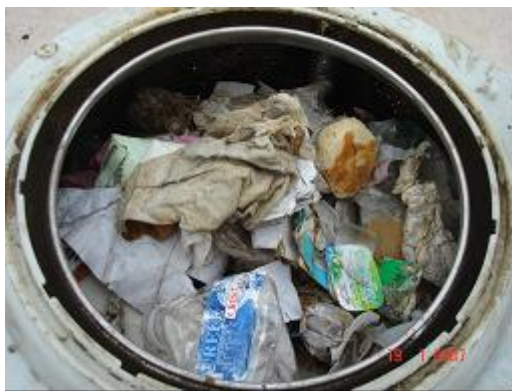
Figure 37 : Photographies de digesteurs remplis de l'inoculum et du substrat à caractériser (fraction 50-100 mm)
