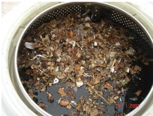
Figure 36 : Photographie de digesteurs remplis de l'inoculum et du substrat à caractériser (fraction 0-20 mm)
