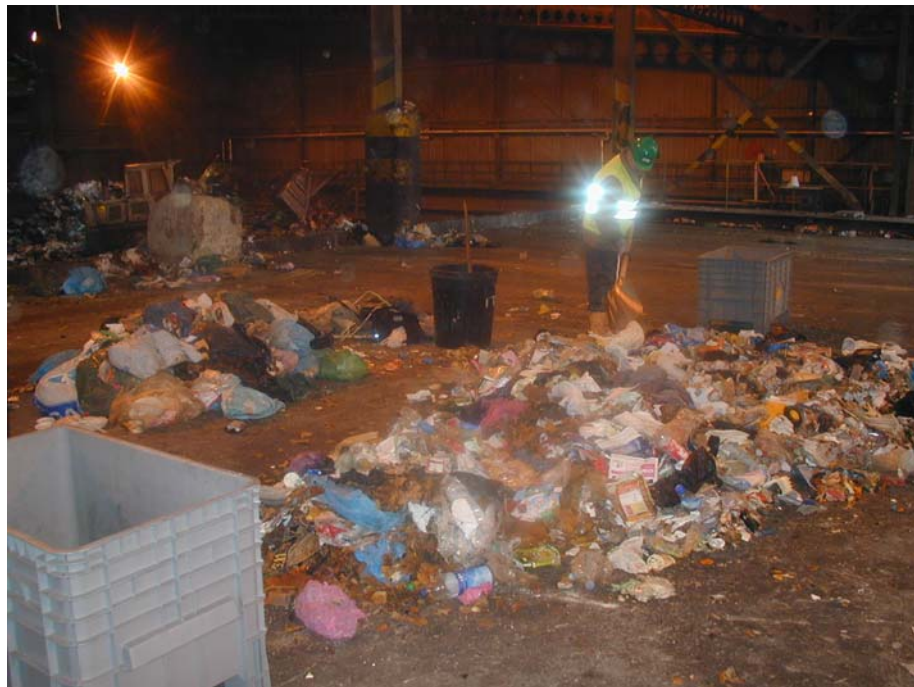
Figure 2 : Pelletage fractionné de la fraction vrac des OMr
