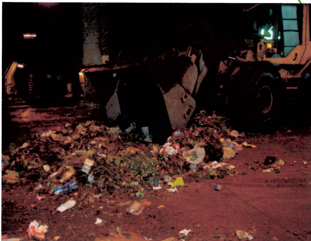
Photo 1 – Vue du bio déchet en cours d'homogénéisation
