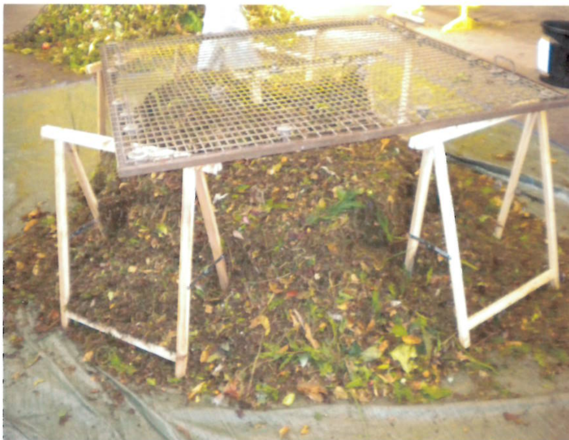
Photo 9 – vue de la table de tri pour séparation des bio déchets verts supérieurs et inférieurs à 20 mm
