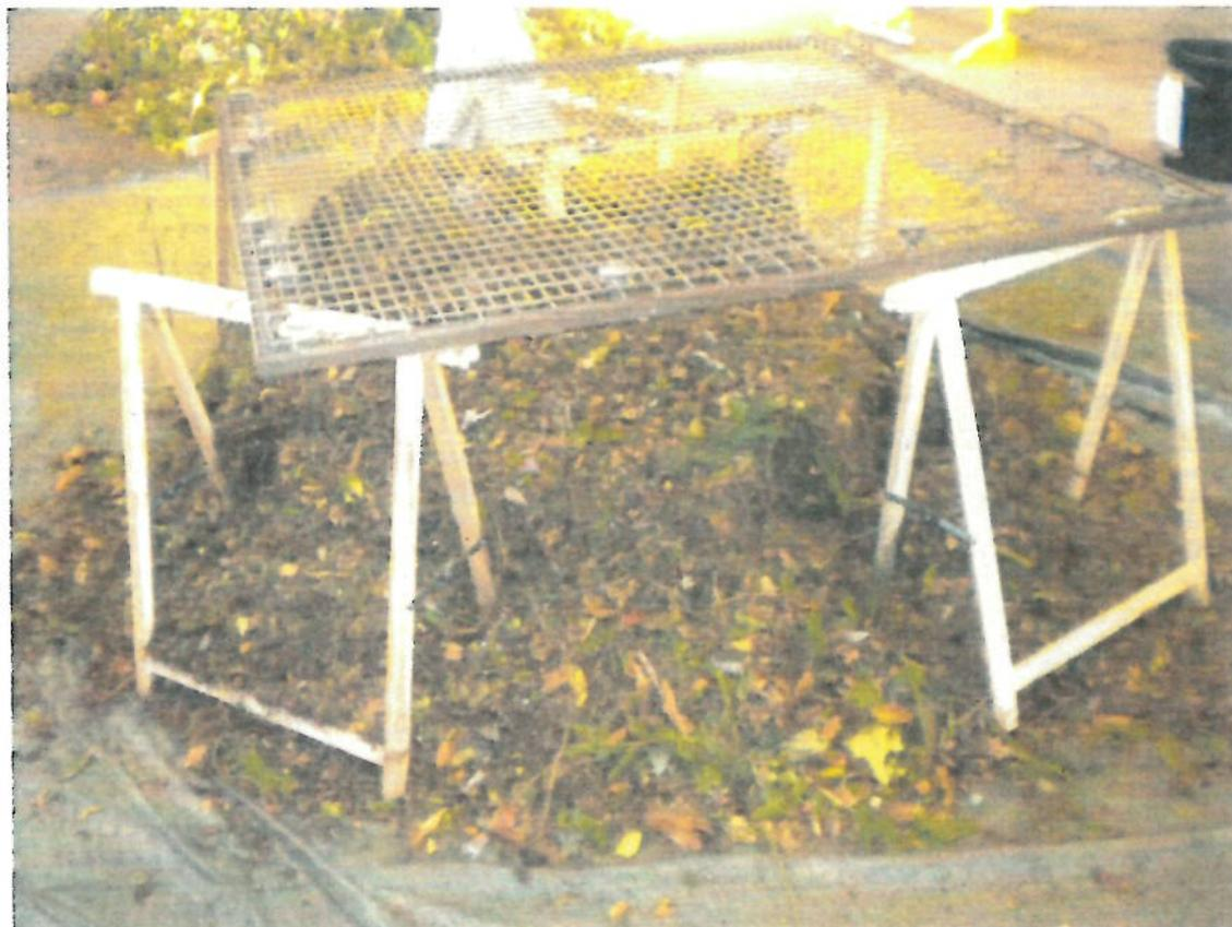
Photo 8 – vue de la table de tri pour séparation des bio déchets verts supérieurs et inférieurs à 20 mm
