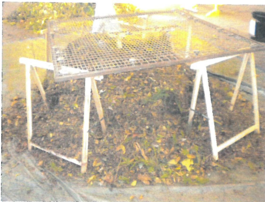
Photo 12 – vue de la table de tri pour séparation des bio déchets verts supérieurs et inférieurs à 20 mm
