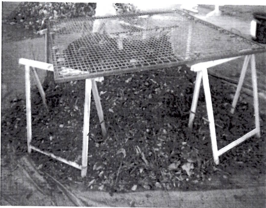
Photo 11 – vue de la table de tri pour séparation des bio déchets verts supérieurs et inférieurs à 20 mm
