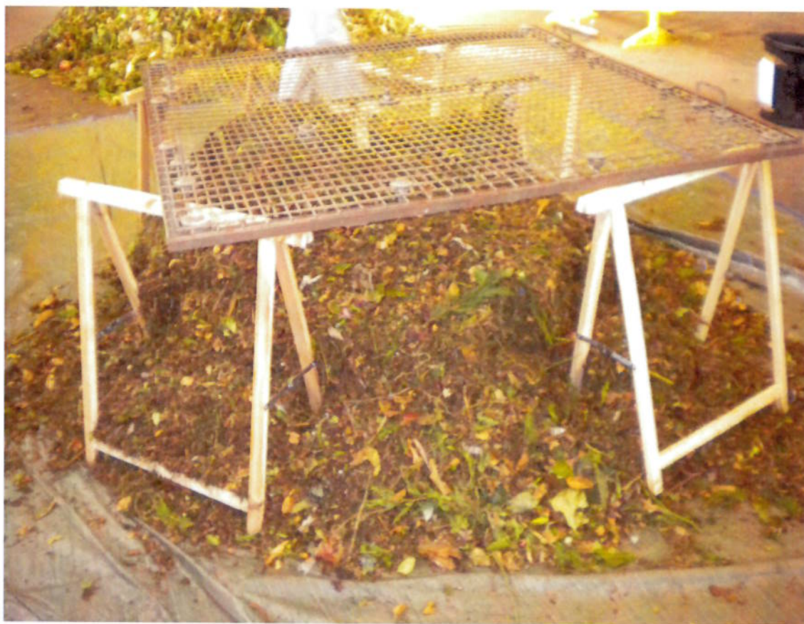
Photo 10 – vue de la table de tri pour séparation des bio déchets verts supérieurs et inférieurs à 20 mm
