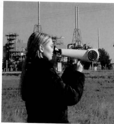
Figure 1 : Mesure des odeurs dans l'environnement à l'aide d'un olfactomètre de terrain
